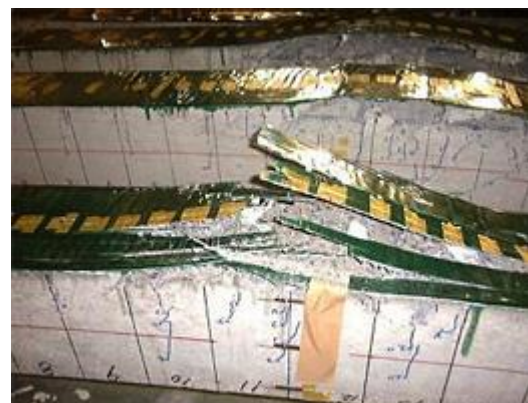
曲げ試験によるシート破断状況
